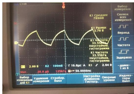
Рисунок 6 – Осциллограмма на выходе 3 ГПН
